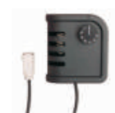
Kamerthermostaat TH 5 met leiding Werkingsbereik: 0-36°C, Precisie: ± 1,5°C 4150.105
