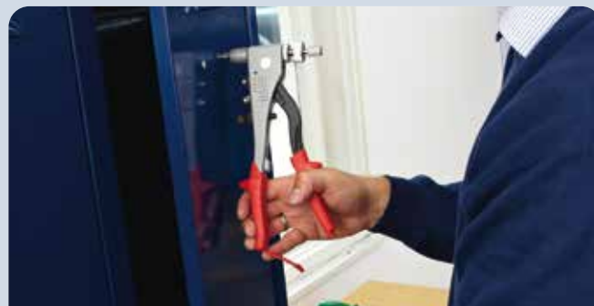
Naambordjes kunnen door middel van klinknageltechniek snel en veilig bevestigd resp. vervangen worden. Zo is bijvoorbeeld de eigen locker in de kleedkamer met een paar handelingen voorzien van een naambordje.
