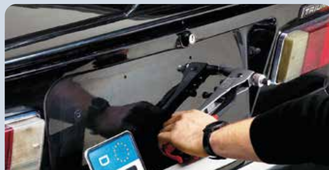
Kentekenplaten kunnen door het schroefdraad in de klinkmoer moeiteloos verwisseld worden.
